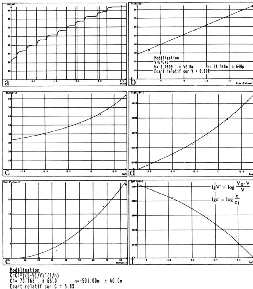
Figure 6 : Le dispositif de la figure 4 est utilisé avec une solution diluée d'alcool - 0.2 % -, le capteur étant branché sur une entrée 100 mV de l'interface (soit un calibre 50 fois inférieur à celui prévu). Le capteur répond, mais les modélisations précédentes ne s'ajustent plus (e) et (f) alors que la relation "brute"  $V/c$  devient quasi linéaire (b).
