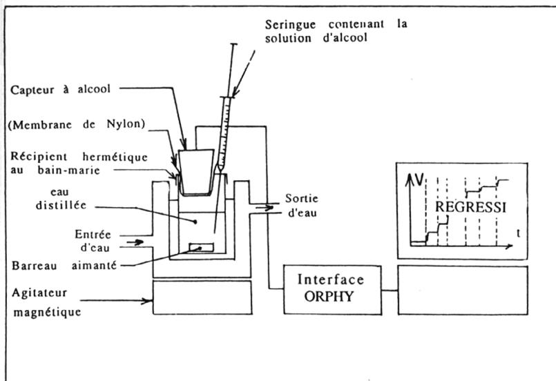
**Figure 4 :** Dispositif thermostaté pour l'étude de fermentations. Pour l'étalonnage, une solution d'alcool est ajoutée par fractions de 0.1 ml dans de l'eau agitée. Une membrane de nylon peut être interposée pour protéger le capteur.
