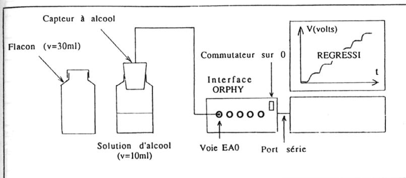
**Figure 2 :** Montage le plus simple pour mettre en évidence et étudier la réponse du capteur à différentes solutions d'alcool (protocole 1).
