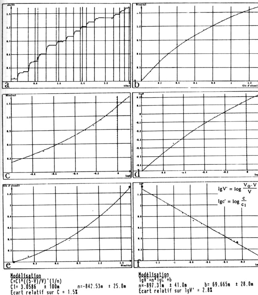
**Figure 5** : Essai avec le dispositif de la figure 4 (protocole 2 à 37 °C). La solution d'alcool ajoutée est à 10 %, le capteur est connecté à une entrée 5 V de l'interface. On voit que la modélisation selon l'équation 1 du texte (e) et la linéarisation log/log (équation 2, courbe f) sont satisfaisantes.
