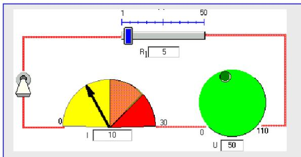
*Exemple de la simulation « Loi d'Ohm » : une interface rapidement créée.*
